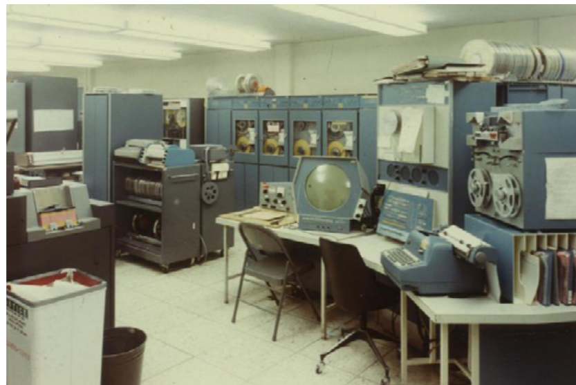
Fig. 6. Computador PDP-1, em setup completo incluindo saída em display de vídeo vetorial, coisa raríssima em 1962.
