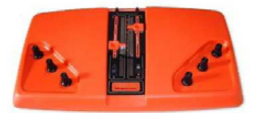
Fig. 21. Magnavox Odyssey 100, um dos muitos consoles baseados no chip General Instruments AY-3-8500, o famoso Pong-On-A-Chip.
