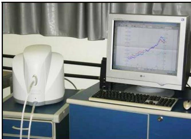
Figura 1: Sistema metabólico de análise de gases (*Medical Graphics® CPX Ultima, Miami, FL, USA*) ligado a um computador (*Pentium 4*)
