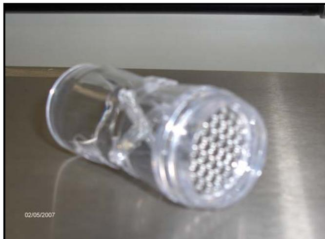
Figura 3: Transdutor de fluxo ou pneumotacógrafo
