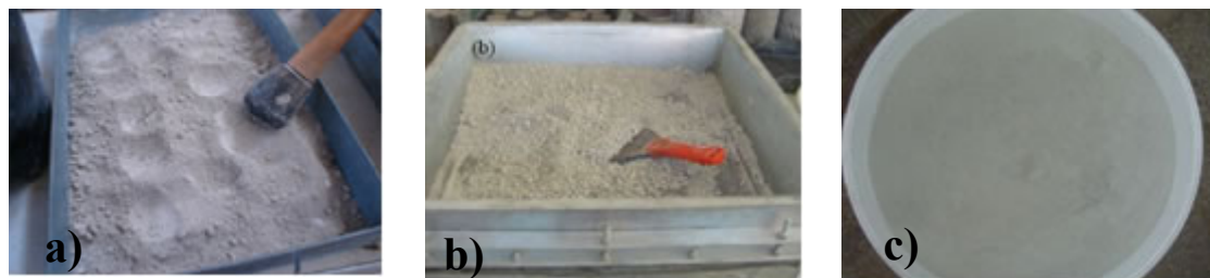
Figura 3.4 – a) Destorroamento; b) Peneiramento; e c) Armazenamento do RBMG.
