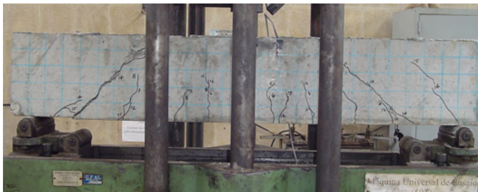
Figura 4.21 – Fissuras na ruptura da viga produzida com o CREF-F.
