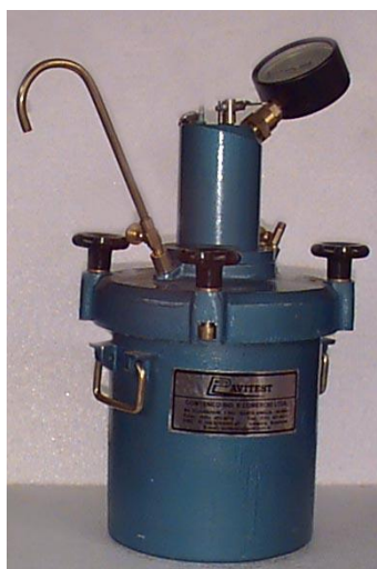
Figura 3.14 – Medidor tipo B para determinação do teor de ar incorporado do concreto fresco.
