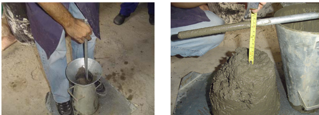
Figura 3.11 – Execução do ensaio de abatimento.
