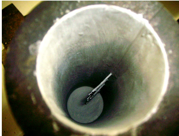
Figura 4.6. Detalhe dos termopares instalados no interior da lingoteira.
