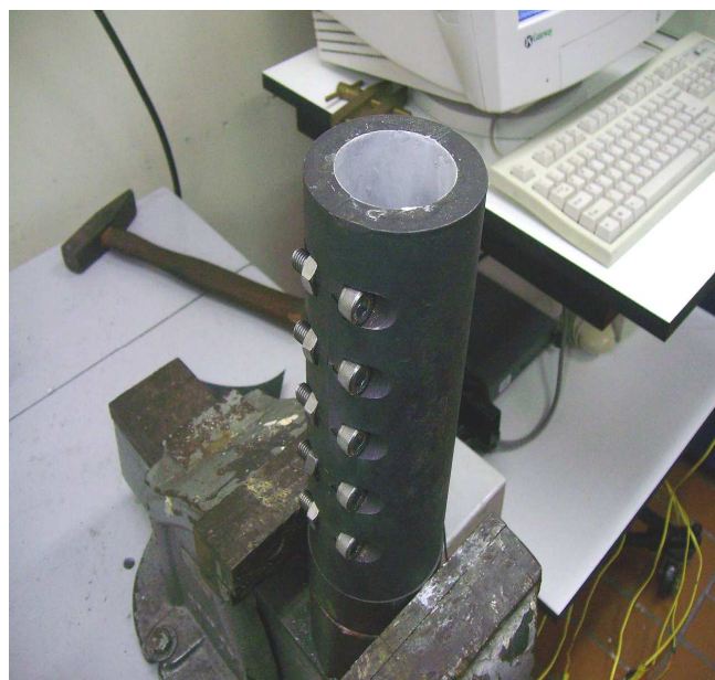
Figura 4.4. (a) e (b) lingoteira de aço inoxidável AISI 304 e partes; (c) dimensões e instalação dos termopares.
