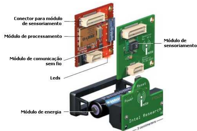
Figura 2.2: Módulos do nó sensor iMote, da família Motes de Berkeley. Fonte: [Culler e Mulder, 2004].
