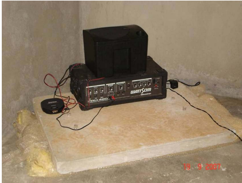
Figura C.1: Fonte Acústica sobre isolamento, no ensaio de Perda por Transmissão
