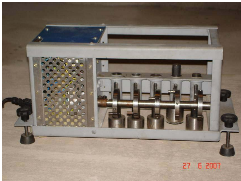
FIGURA 33 – Máquina geradora de ruído de impacto – Padrão ISO 140-7
