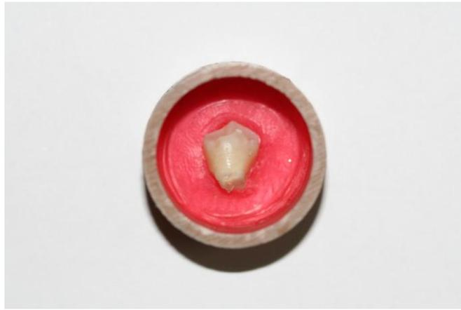
Figura 3 – Fixação da unidade no centro do cilindro
