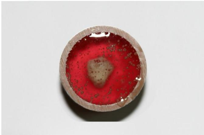
Figura 4 – Preenchimento integral do cilindro de PVC com a resina ortoftálica
