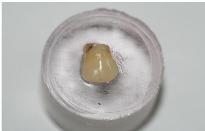
Figura 5 – Porção coronária incluída em resina ortoftálica, constituindo-se no corpo-de-prova
