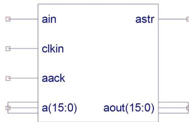
**Figura 5.13:** Bloco esquemático do operador INDATA.
