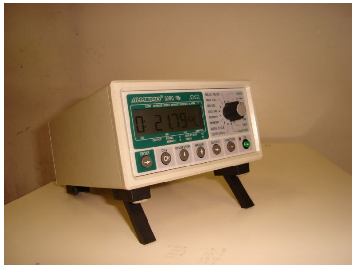
Figura 3.2 – Data Logger ALMEMO 3290-8.
