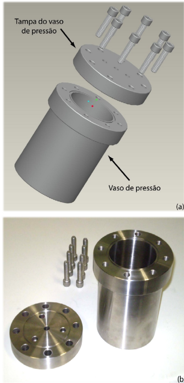
Figura 4.1. Desenho do projeto do vaso de pressão do reator (a) e fotografia do reator em aço inoxidável AISI 304 depois do processo de usinagem (b).
