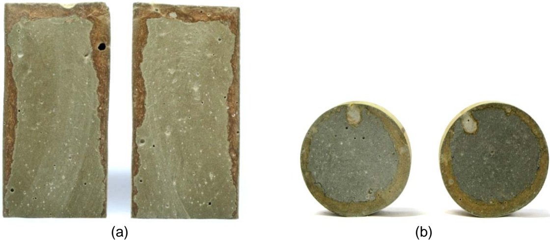
Figura 5.3. Seção longitudinal (a) e transversal (b) dos corpos-de-prova de pasta de cimento após os ensaios de degradação durante 14 dias em água saturada com \text{CO}_2 .
