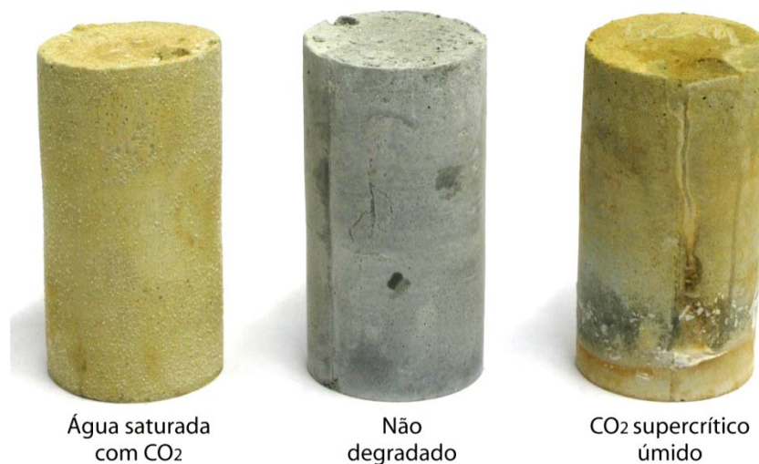
Figura 5.2. Alteração de coloração observada nos corpos-de-prova em ambos os meios de degradação.
