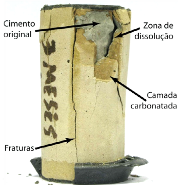
Figura 5.25. Corpo-de-prova com 84 dias de reação em água saturada com \text{CO}_2 após o ensaio de resistência à compressão.
