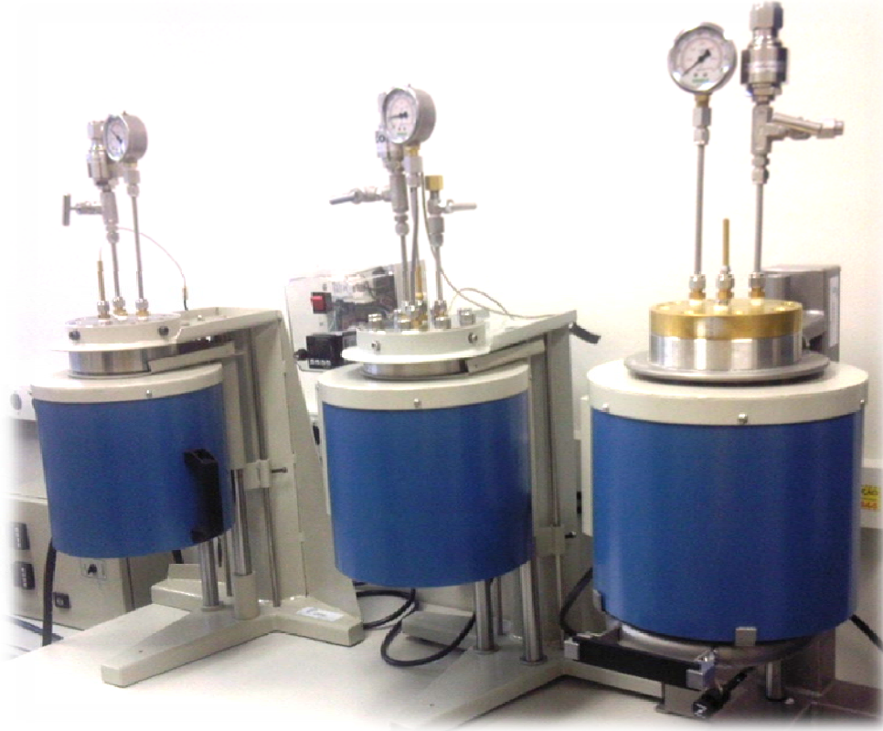
Figura 4.4. Reatores construídos para avaliar a integridade dos materiais empregados na construção de poços.
