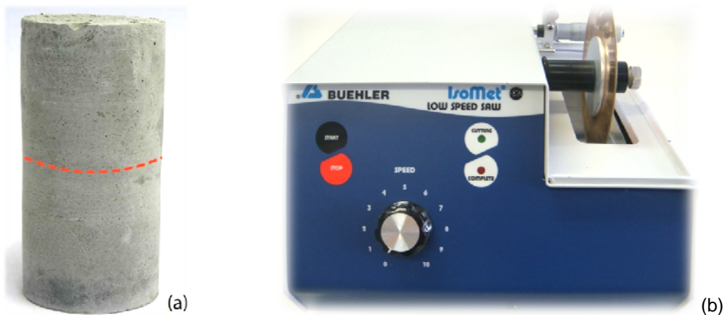
Figura 4.9. Fotografia indicando a região onde foram seccionados os corpos-de-prova para caracterização por microscopia e microdureza (a) e fotografia da serra de disco diamantado (b).
