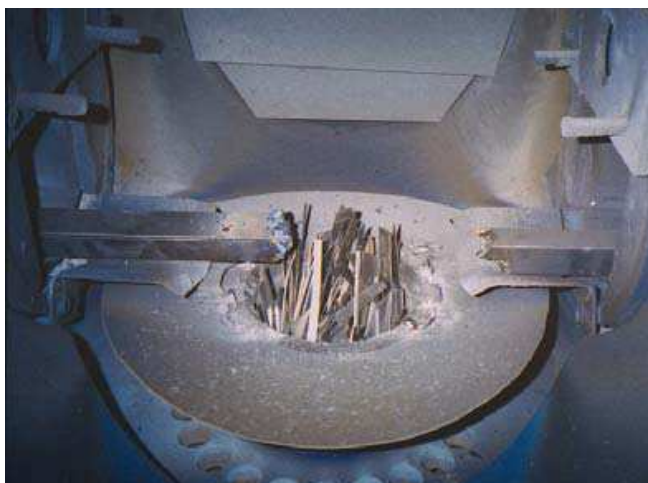
Figura 3.13. Pedaços de Ni+Ti montados sobre os pivôs dentro do cristalizador. Vêem-se também duas barras de alimentação [Otubo, 2005].
