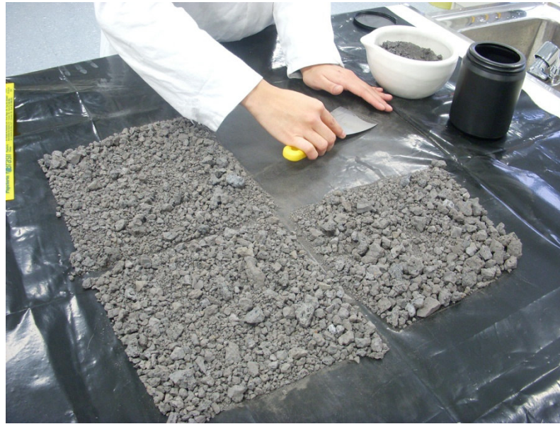
Figura 4.2. Quarteamento realizado para que a amostragem fosse significativa.
