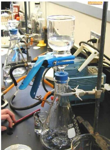
Figura 13 – Conjunto filtrante Millipore XX1004700
