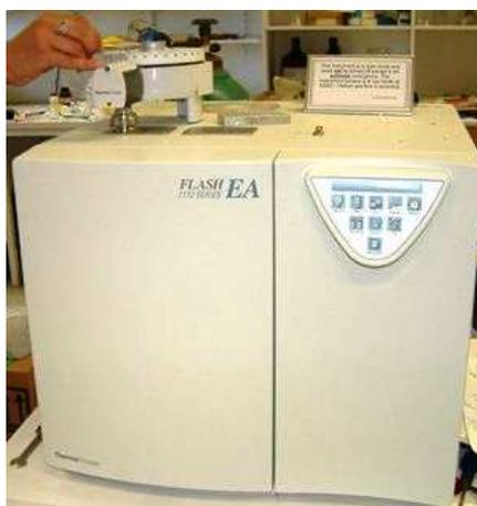
Figura 15 – Analisador de CHN EA Flash 1112 Series
