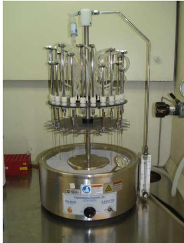
Figura 10 – Evaporador de nitrogênio N-EVAP 11250-G
