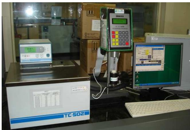
Figura 8 – Reômetro programável Brookfield DVIII Ultra
