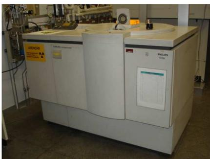
Figura 12 – Espectrômetro de fluorescência de raios-X Philips PW 2400
