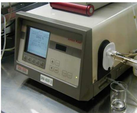
Figura 7 – Densitômetro DMA 5000
