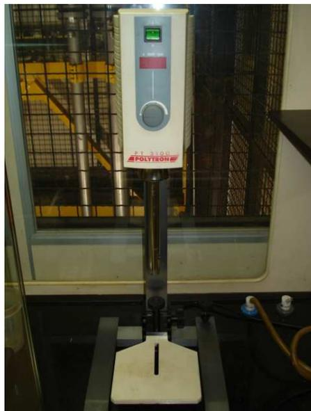
Figura 21 – Homogeneizador Polytron PT 3100
