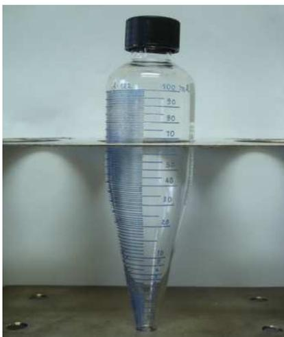
Figura 22 – Tubo graduado de teste de garrafa
