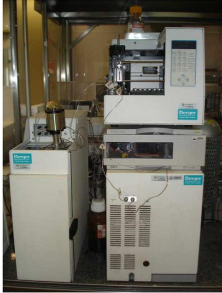
Figura 9 – Cromatógrafo Analytix Supercritical Fluid Chromatography
