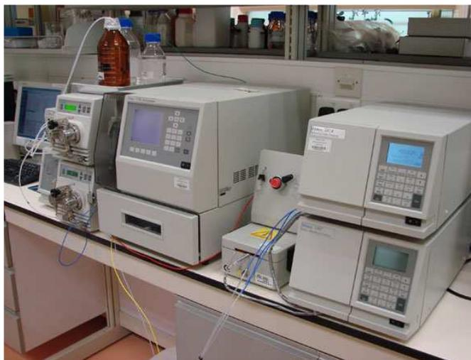
Figura 14 – Sistema Waters de Cromatografia de Permeação em Gel (GPC)
