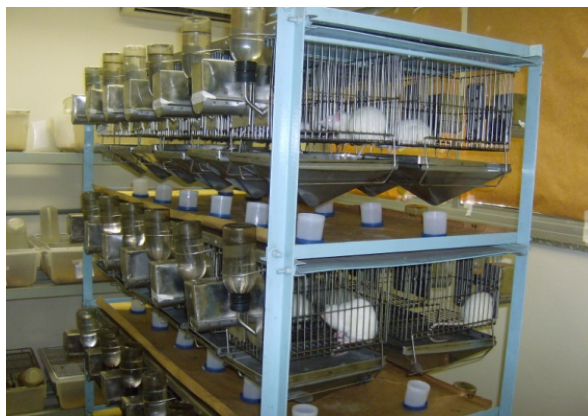
Figura 2: Gaiola semi-metabólica utilizada para acondicionamento de animais no experimento de diurese com o extrato aquoso liofilizado de Vetiveria zizanioides
