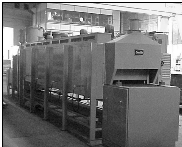
Figura 25: Forno contínuo a gás.
