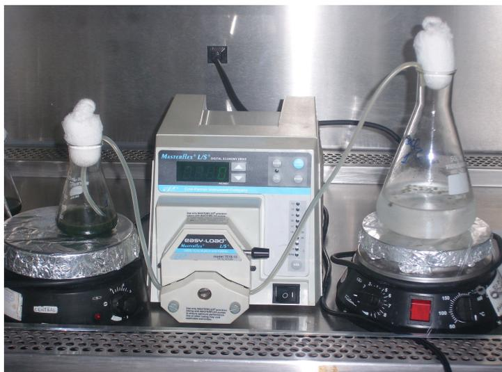
Figura 3.1 Aparato experimental utilizado para imobilização do microrganismo.
