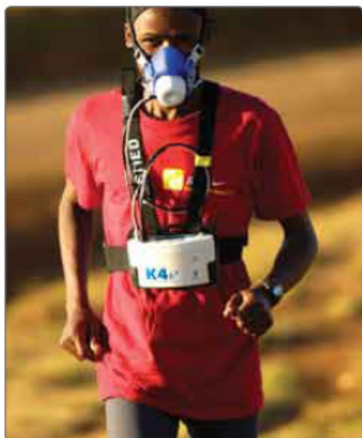
Figura 12 – Atleta tendo sua capacidade respiratória analisada por meio do K4b 2 (Cortesia: Cosmed)
