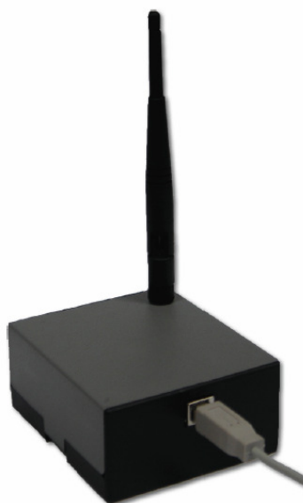
Figura 20 – Aspecto final da estação rádio base
