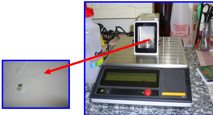
Figura 4.6 – Pesagem do pó da resina fotopolimerizada, em balança analítica.
