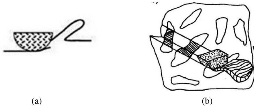
Figura 5.30 – vista frontal (a) e vista superior (b) do início do arrancamento das partículas de desgaste por microabrasão.
