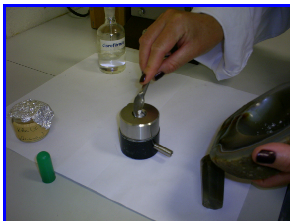
Figura 4.7 – Colocação da Mistura em molde especial.
