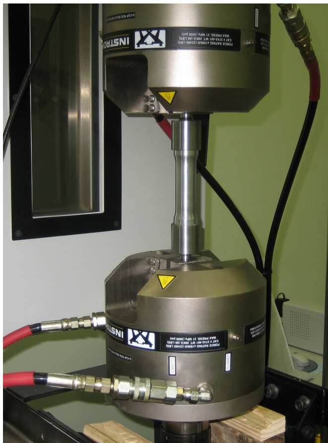
Figura 3.7 – Ensaio de fadiga utilizando a metodologia A
