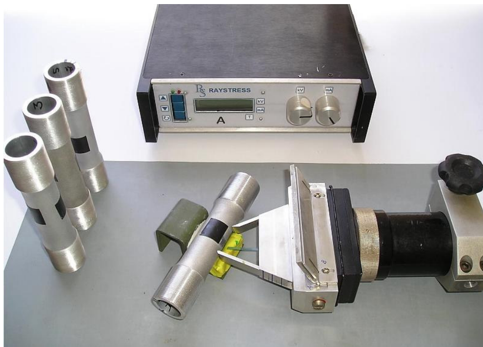
Figura 3.16 – Processo utilizado para medir as tensões residuais em um corpo-de-prova com o equipamento RAYSTRESS® (CORTESIA GURTEQ – Ensaios Não Destrutivos)
