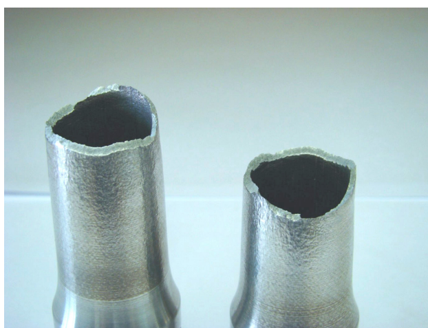
Figura 4.2 – Corpo-de-prova fraturado no ensaio de tração
