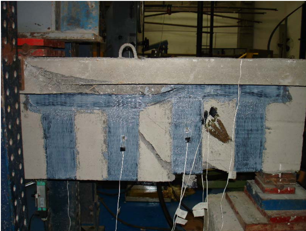
Foto A.33 – Detalhe da ruptura da viga VII-2 (1).
