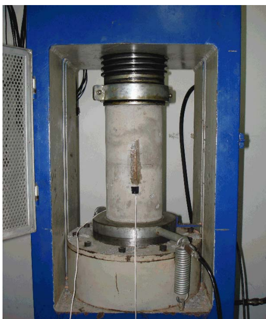
Foto A.2 – Sistema de aplicação de força em corpo-de-prova para determinação do módulo de elasticidade do concreto.
