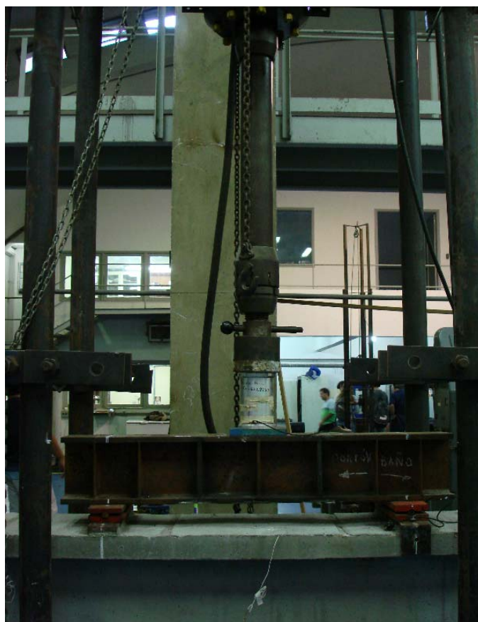
Foto A.18 – Sistema aporcado para aplicação de força até 1000 kN.
