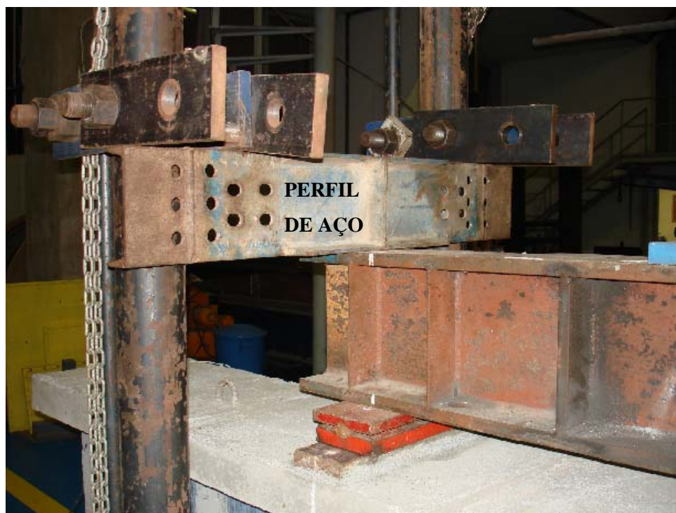
Foto A.20 – Perfil de aço utilizado no travamento da viga de concreto no sistema aporticado para força até 1000 kN.
