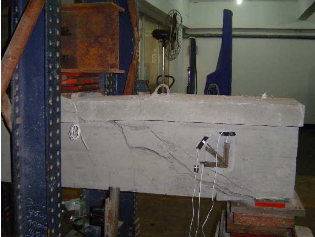
Foto A.29 – Detalhe da ruptura da viga VR2 (1).
