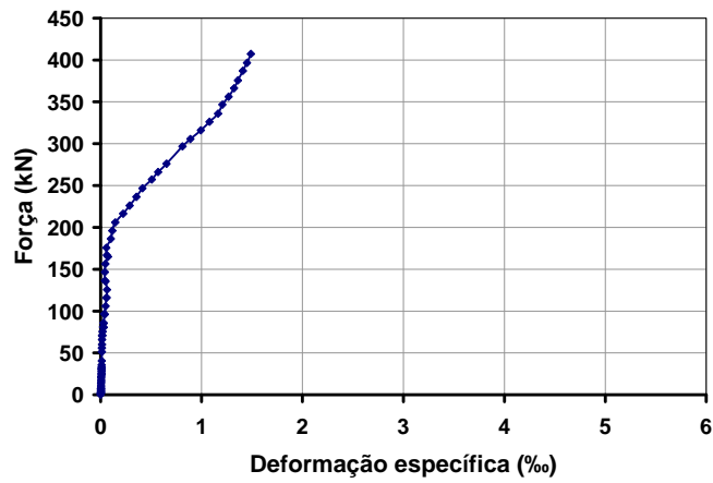
Figura E.4 – Diagrama força x deformação específica do aço referente ao extensômetro SG4 colado num estribo da viga VR1.
