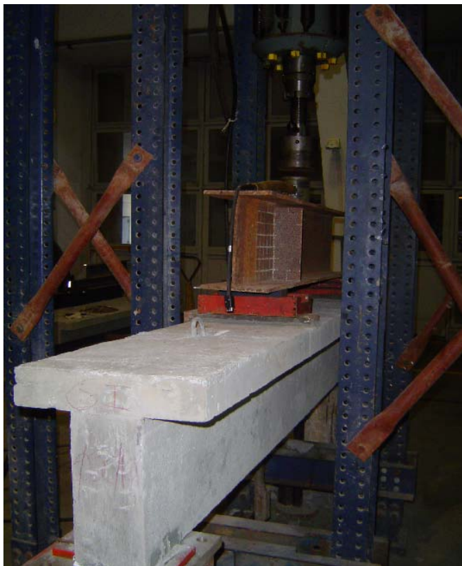
Foto A.17 – Sistema aporcado para aplicação de força até 500 kN.
