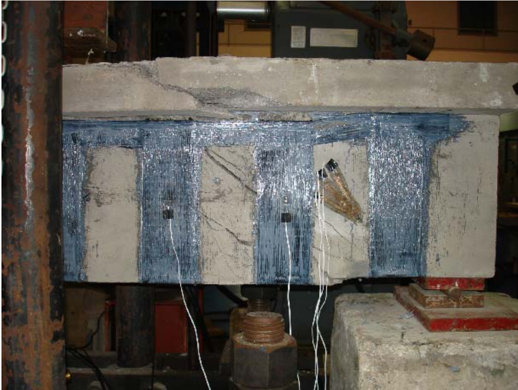
Foto A.35 – Detalhe da ruptura da viga VII-3 (1).
