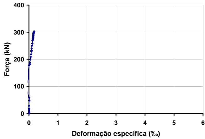
Figura E.44 – Diagrama força x deformação específica do aço referente ao extensômetro SG2 colado num estribo da viga VR2.
