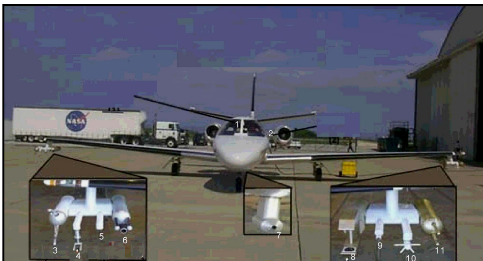
Figura 2.5 - Avião Citation II e localização de alguns equipamentos: câmara (1); temperatura do ponto de orvalho (2); 1-DP (3); conteúdo de água líquida (4); temperatura ambiente (5); FSSP (6); CPI (7); HVPS (8); tubo de Pitot (9); temperatura de fluxo reverso (10); 2-DC(11).
