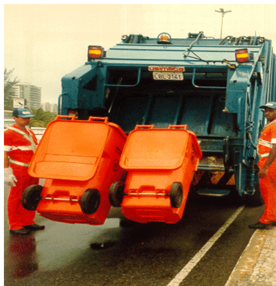
Figura 5 – Veículo Compactador usando Sistema Bascular com Contêiner
