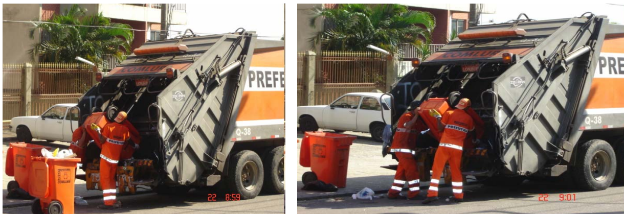
Figura 6 – Garis utilizando Sistema de Elevadores de Contêineres
