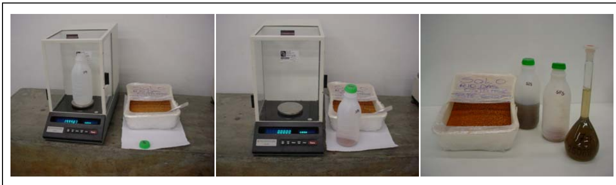
Fig. 4.3 – Pesagem do solo no frasco
