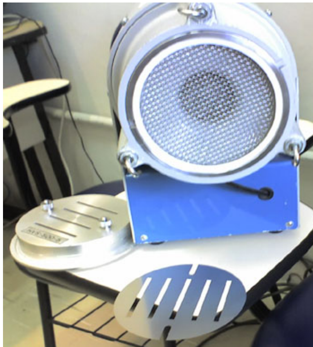
Figura 2.5: Amostrador SIBATA, com filtro de fenda de corte 10 \mu m sobre a bancada e a grade de entrada de ar (sem o filtro de fibra de vidro).
