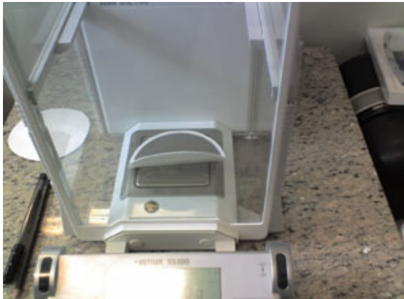
Figura 2.6: Pesagem do filtro de fibra de vidro antes e após amostragem. No prato encontra-se um filtro após amostragem e sobre a bancada, um limpo.
