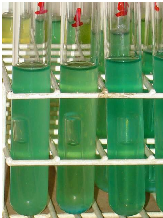
Figura 4.5. Tubos múltiplos apresentando tubos de Durham com gás e turvação do meio, prova confirmativa em caldo lactosado com verde brilhante e bile à 2% para presença de coliformes totais.
