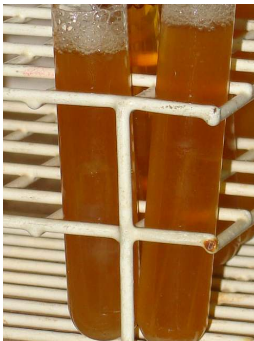
Figura 4.6. Tubos múltiplos apresentando tubos de Durham com gás e turvação do meio, prova confirmativa em meio EC para presença de coliformes fecais ou termotolerantes.
