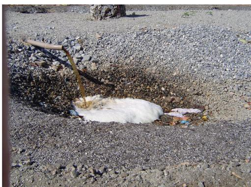
Figura 23- Cone de infiltração de chorume
