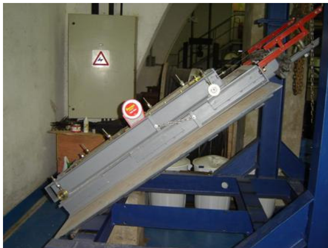
Figura 32 - Ensaio de rampa após a ruptura
