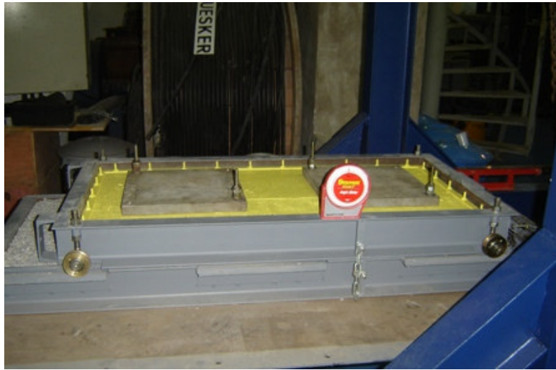
Figura 28 - Conclusão da preparação do corpo de prova para o ensaio de rampa (tensão confinante intermediária)
