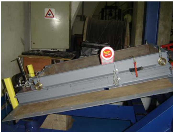
Figura 33 - Plataforma durante o ensaio de cisalhamento direto inclinado
