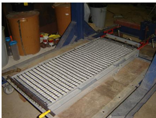
(c) Geossintético instalado
