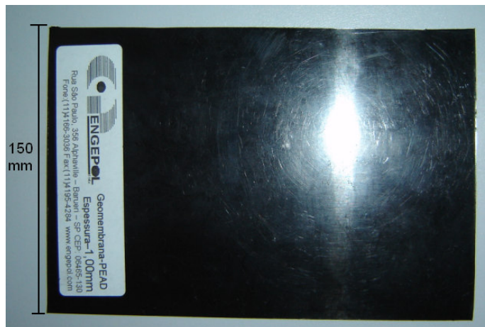
Figura 26 - Amostra representativa da Geomembrana (GM) ensaiada
