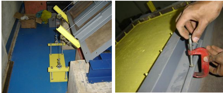
(a) Plataforma de aplicação de cargas (b) Grampo tipo C para unir as caixas
