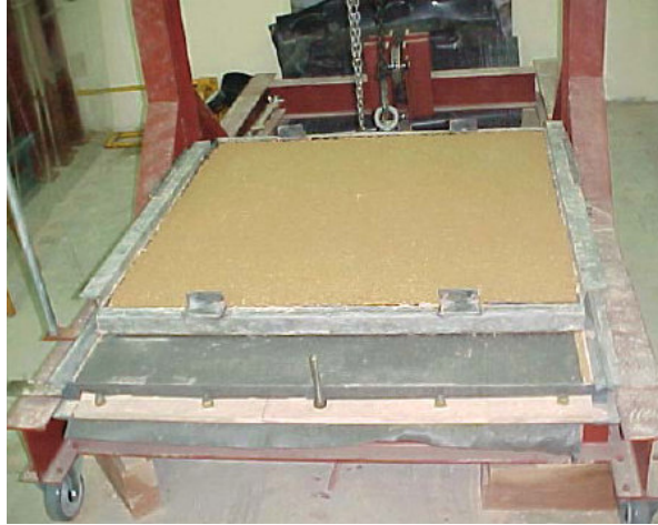
Figura 21 - Equipamento de Rampa da PUC-Rio (Aguiar, 2003)
