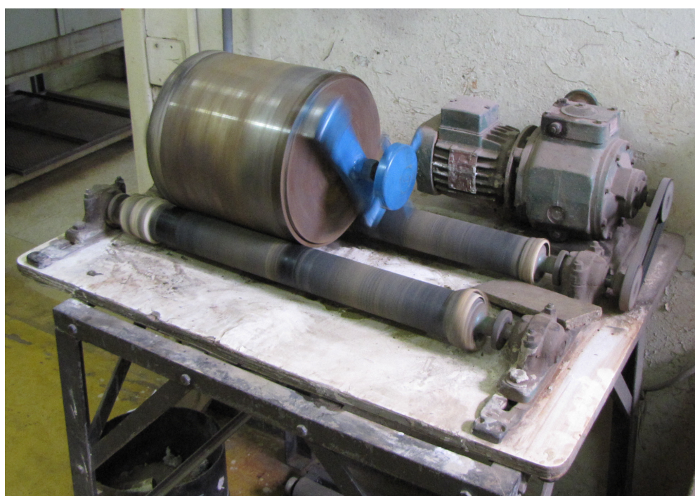
Figura 5.10 - Moinho de laboratório utilizado no teste padrão de Austin.
