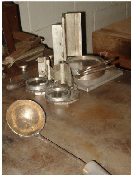
Figura 29- Instrumentos para capeamento.
