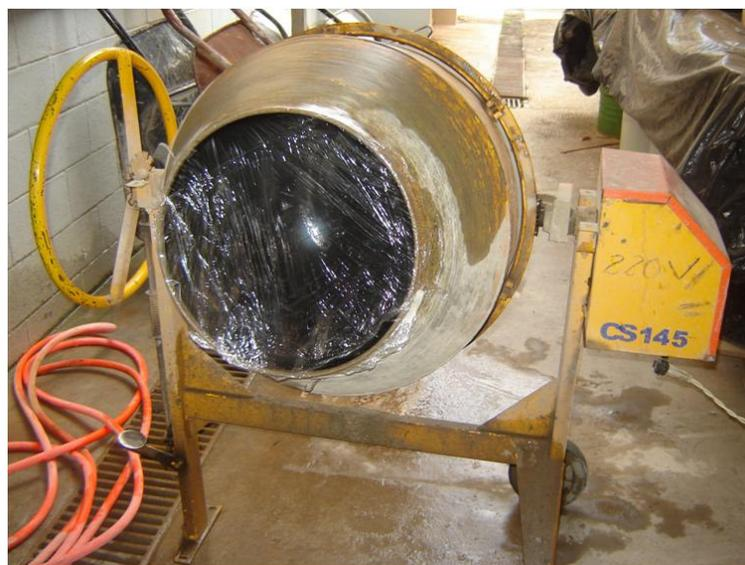
Figura 66- Vedação da Betoneira para o traço ASM 10.
