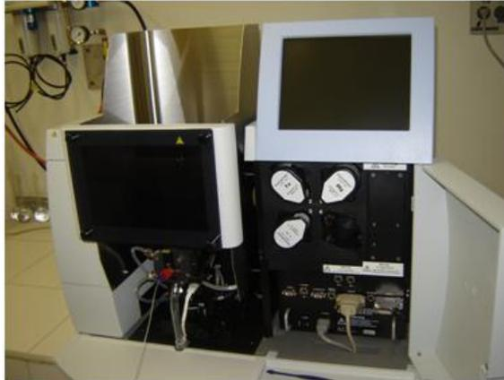
Figura 21- Espectrofotômetro de Absorção Atômica marca Perkin Elmer modelo Analyst 200.
