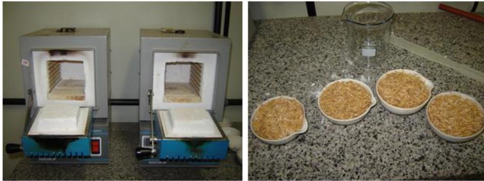
Figura 20- Muflas marca Marconi utilizadas na calcinação e amostras de cascas de arroz.
