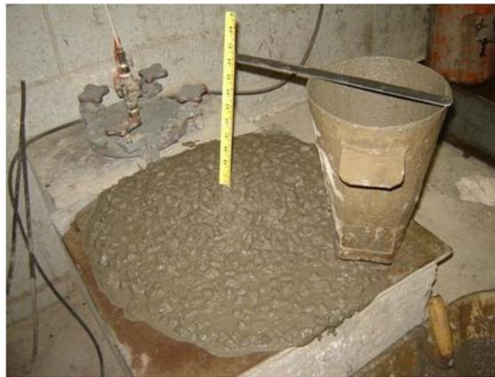
Figura 34- Abatimento do Tronco de Cone.
