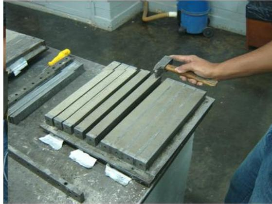
Figura 31- Desmoldagem dos corpos-de-prova.
