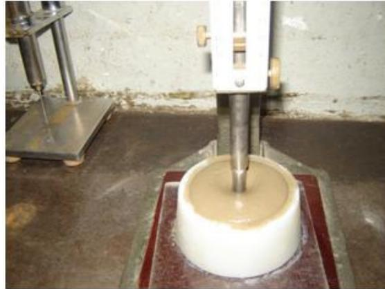
Figura 23- Determinação da quantidade de água.
