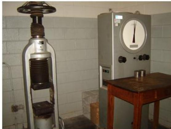
Figura 38- Máquina para ensaio marca Wolpert.
