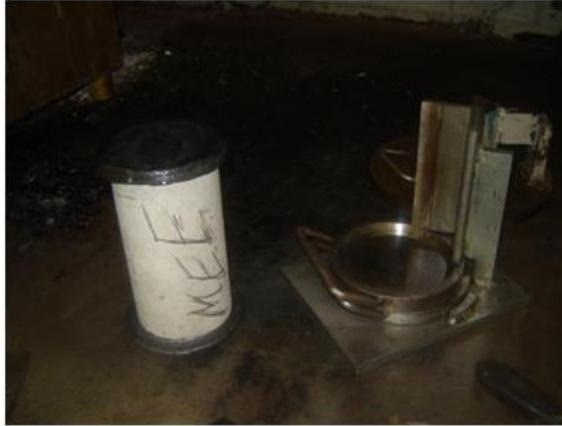
Figura 37- Corpo-de-prova capeado com enxofre.
