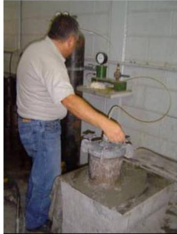
Figura 35- Medidor de Ar.
