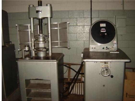
Figura 30- Máquina para ruptura dos cps marca Maruto.
