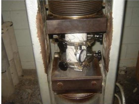
Figura 39- Execução do ensaio de Módulo de Elasticidade.
