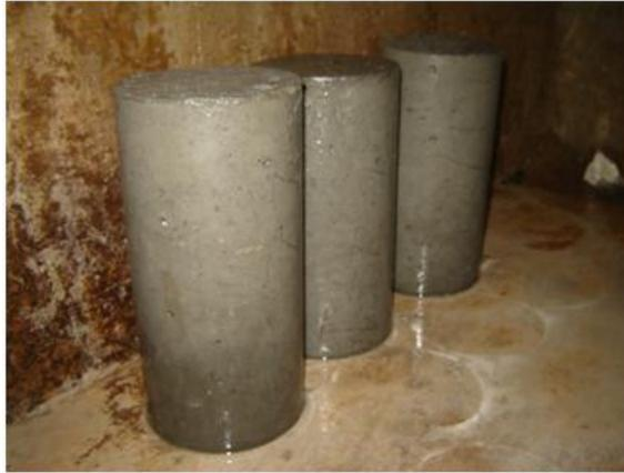
Figura 33- Cura dos cps em câmara úmida.
