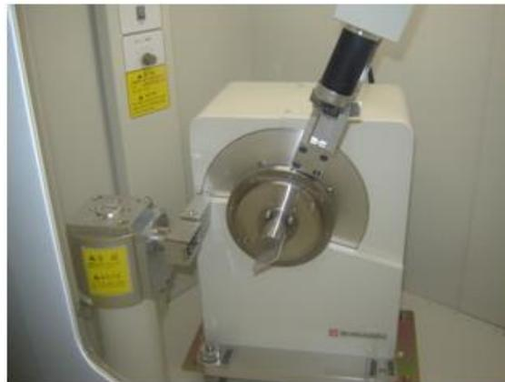
Figura 22- Diffractômetro de Raios-X marca Shimadzu, modelo XRD - 6000.
