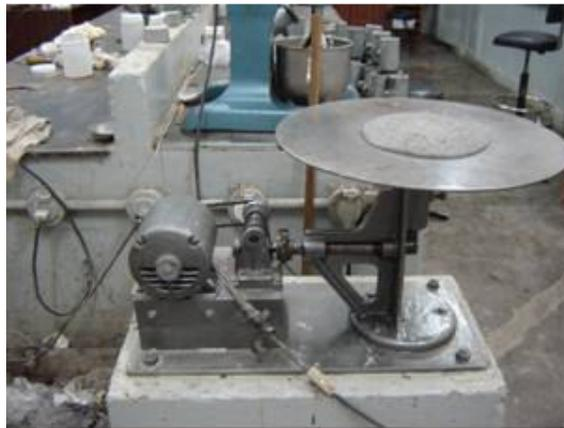
Figura 27- Mesa do aparelho de consistência.
