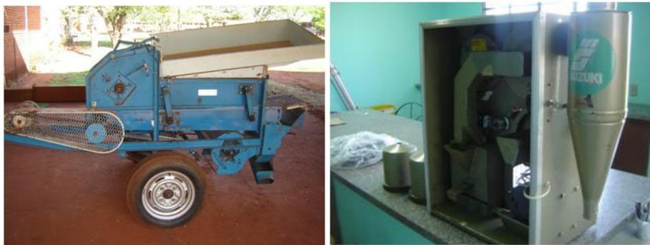
Figura 18- Máquina de trilhagem e Máquina de beneficiamento de arroz.
