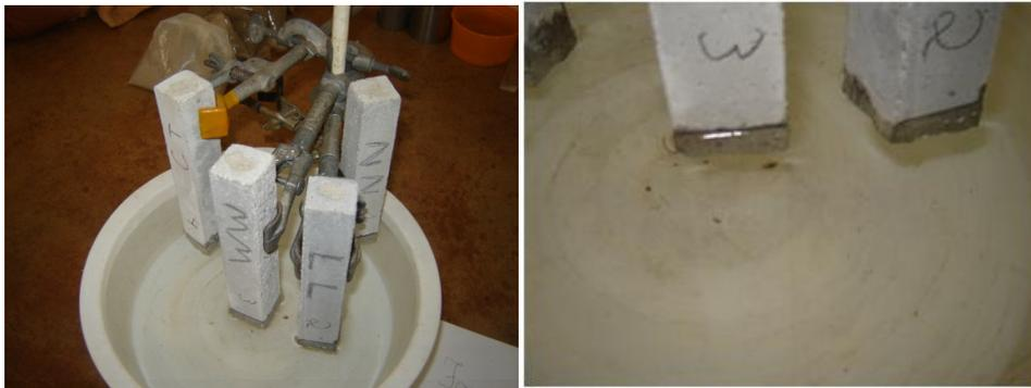
Figura 32- Execução do ensaio de absorção por capilaridade.
