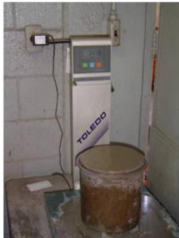
Figura 36- Determinação da Massa Específica.
