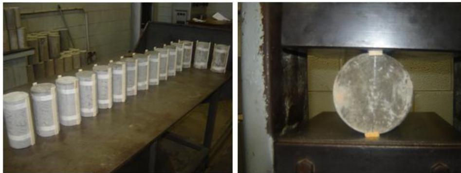
Figura 40- Execução do ensaio à tração por compressão diametral.
