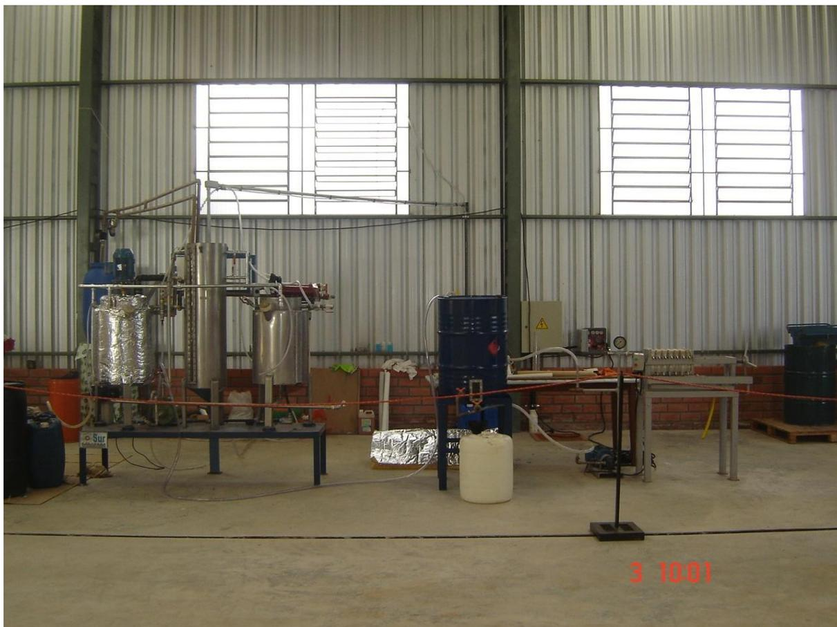
Figura 3 - Equipamento desenvolvido na UNISC para produção de biodiesel em escala piloto.
