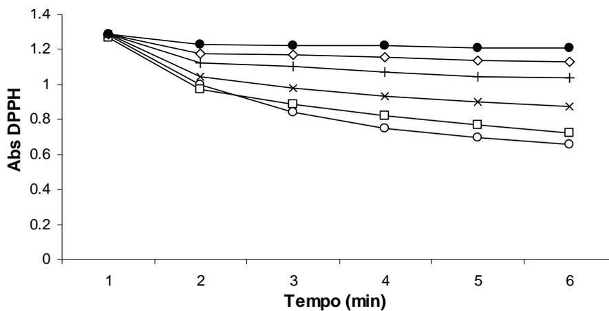
**Figura 19:** Avaliação da capacidade antioxidante da fração clorofórmica (FC): 250µg/mL (-○-), 125µg/mL (-□-), 62.5 µg/mL (-x-), 31.25 µg/mL (-+-), e 15.625 µg/mL (-◇-), 7,8125µg/mL (-●-). Os valores estão mostrados em absorvância de DPPH no eixo das ordenadas e Tempo em minutos nas abscissas.
