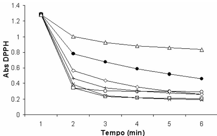
**Figura 20:** Avaliação da capacidade antioxidante da fração acetato de etila: 250µg/mL (-○-), 125µg/mL (-□-), 62.5 µg/mL (-x-), 31.25 µg/mL (-+-), e 15.625 µg/mL (-◇-), 7,8125µg/mL (-●-). Os valores estão mostrados em absorvância de DPPH no eixo das ordenadas e Tempo em minutos nas abscissas.
