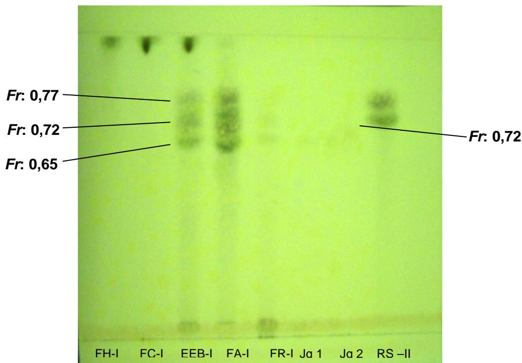
**Figura 7:** Cromatograma em fase normal das amostras fração hexânica (FH-I), fração Clorofórmica (FC-I), extrato etanólico bruto (EEB-I), fração acetato de etila (FA-I), fração residual (FR-I), Jg 1, Jg 2 e resíduo sólido (RS -II) – (acetato de etila/ácido fórmico/ácido acético glacial/água - 100:11:11:26; revelado com FeCL3 a 1%).
