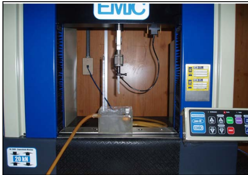
Figura 6. Caixa de acrílico posicionada na máquina universal de ensaios.
