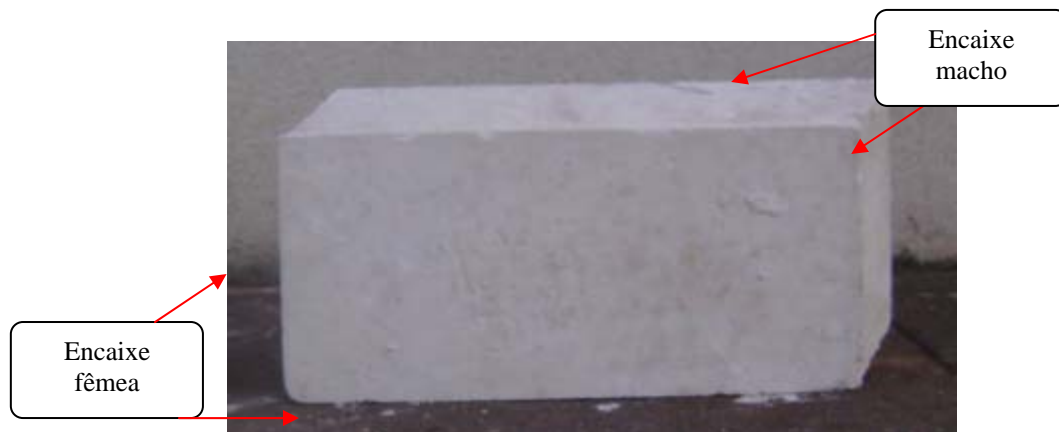
Foto 5.2 – Bloco com encaixe macho fêmea.
