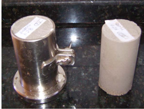
Foto 5.14 – CP 5 x 10 cm para ensaio de resistência a compressão de argamassas.
