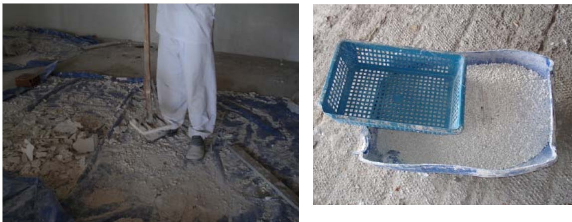
Foto 2.3 – (a) Sobra de gesso sendo triturada. (b) “Peneira” utilizada para padronizar a granulometria e a sobra de gesso utilizada (RIBEIRO, 2008).
