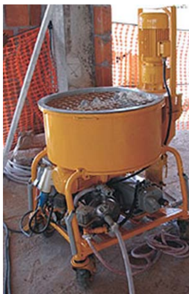
Foto 3.2 – Equipamento de projeção de revestimento de gesso (GEROLLA, 2008).
