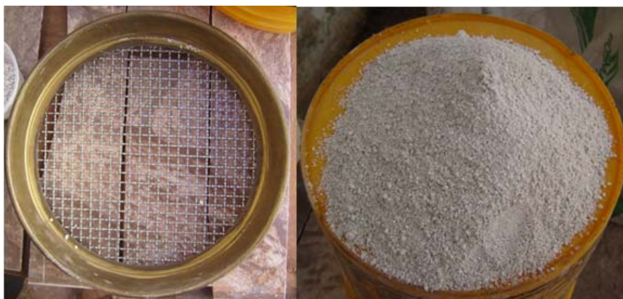
Foto 4.7 – Gesso Úmido – Granulometria 1– fina.
