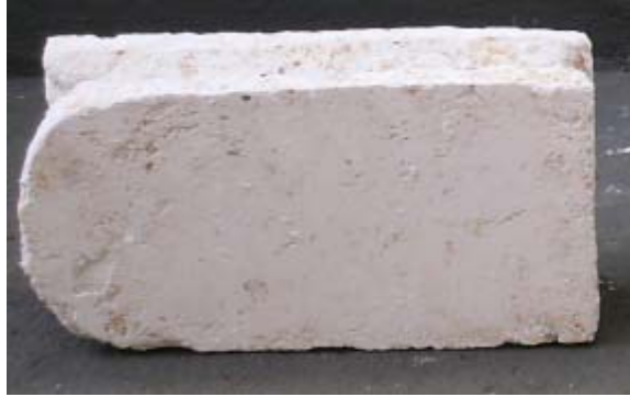
Foto 5.1 – Bloco de Gesso Reciclado.
