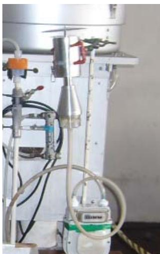
**Figura 8.** *Impactador  $MP_{10}$  low-vol.*
