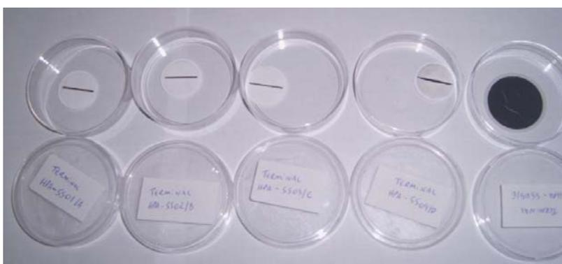
**Figura 17.** Filtros amostrados pelo impactador Sioutas em 168 horas de coleta.
