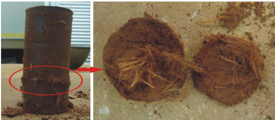
Figura 4.2: Detalhe da aglomeração de fibra no plano de ruptura.
