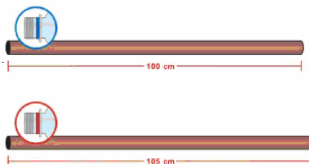
Figura 41 – Corte dos Tubos do Coletor para garrafas de Pepsi-Cola e Coca-Cola respectivamente. Fonte: Secretaria do Meio Ambiente e Recursos Hídricos – SEMA (2006).
