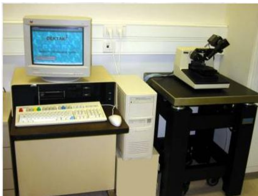
Figura II.3.4: Imagem do perfilômetro modelo Dektak3 [63].
