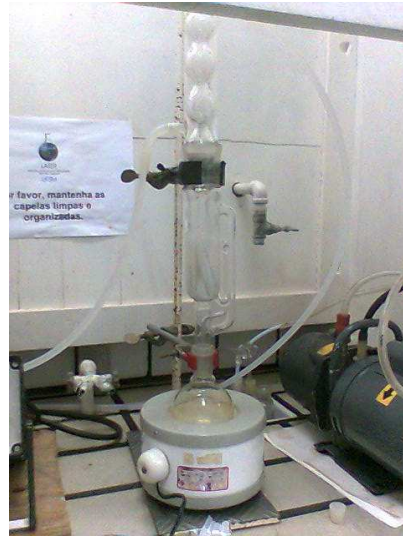
FIGURA 9. Extração Soxhlet. (a) manta de aquecimento; (b) balão de fundo redondo (200 mL) com solvente; (c) sifão; (d) cartucho de amostras; (e) câmara de extração; (f) condensador.
