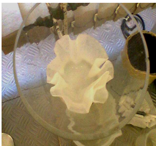
FIGURA 31. Lodo gerado no processo de eletrocoagulação da solução desprovida dos analitos SMX e TMP.
