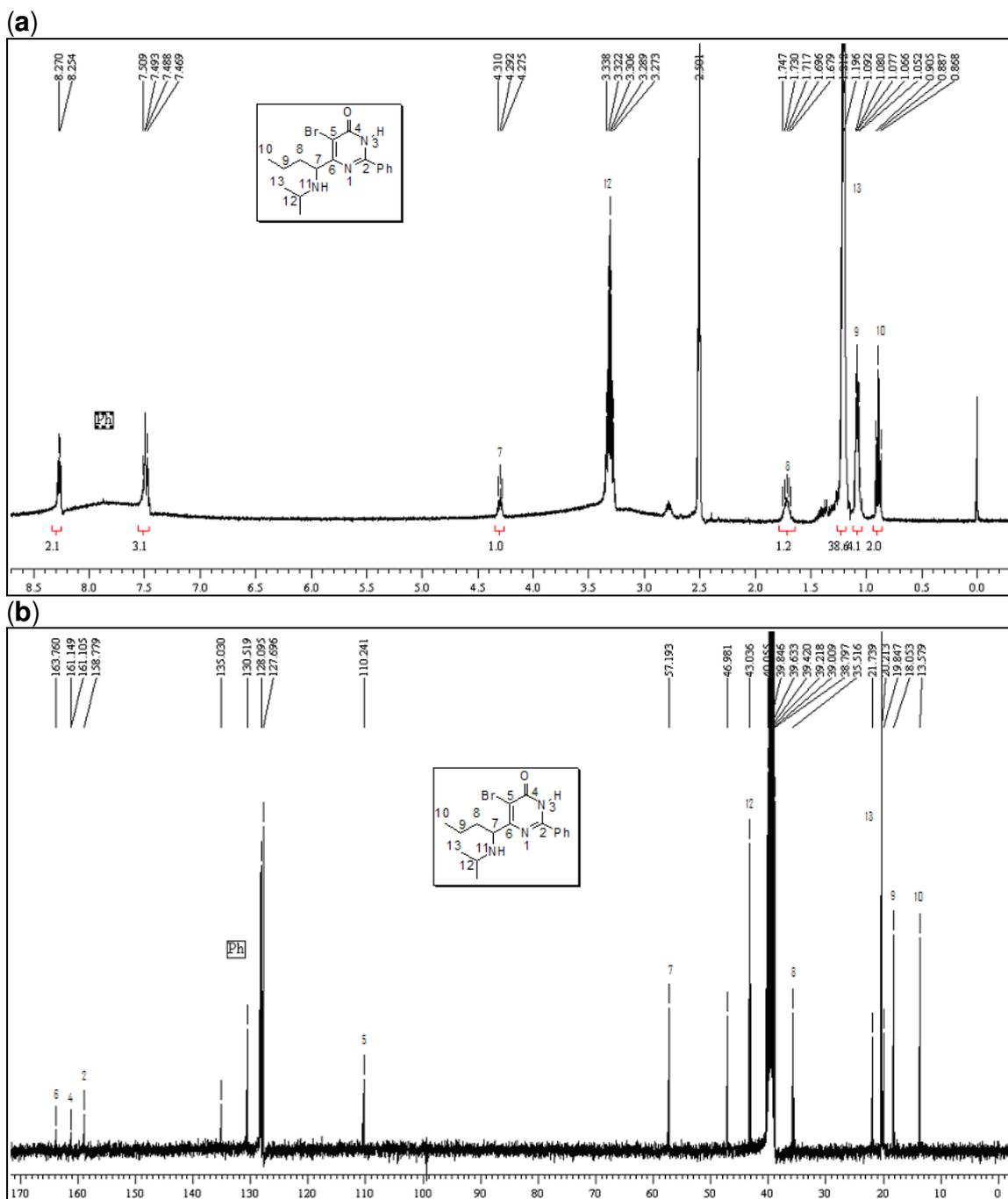
Figura 45: Espectro de (a) RMN  $^1\text{H}$  a 400 MHz em  $\text{DMSO}-d_6$  e espectro de (b) RMN  $^{13}\text{C}$  a 100 MHz em  $\text{DMSO}-d_6$  para o composto **11d**.
