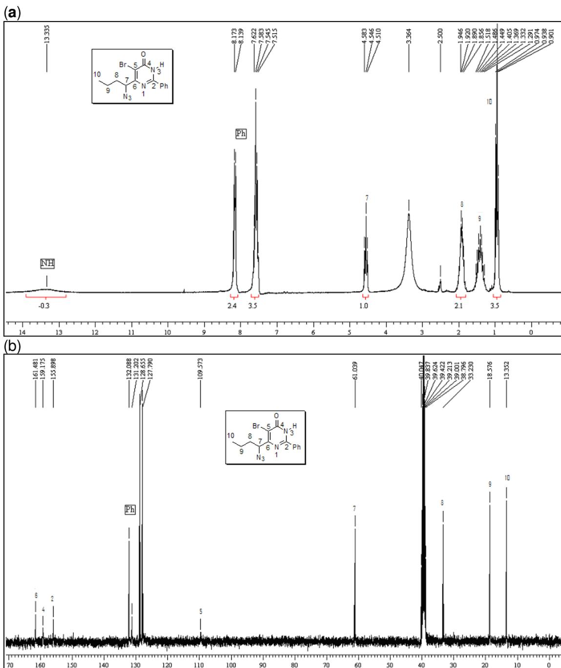
Figura 31: Espectro de (a) RMN  $^1\text{H}$  a 200 MHz em  $\text{DMSO}-d_6$  e espectro de (b) RMN  $^{13}\text{C}$  a 100 MHz em  $\text{DMSO}-d_6$  para o composto **7d**.
