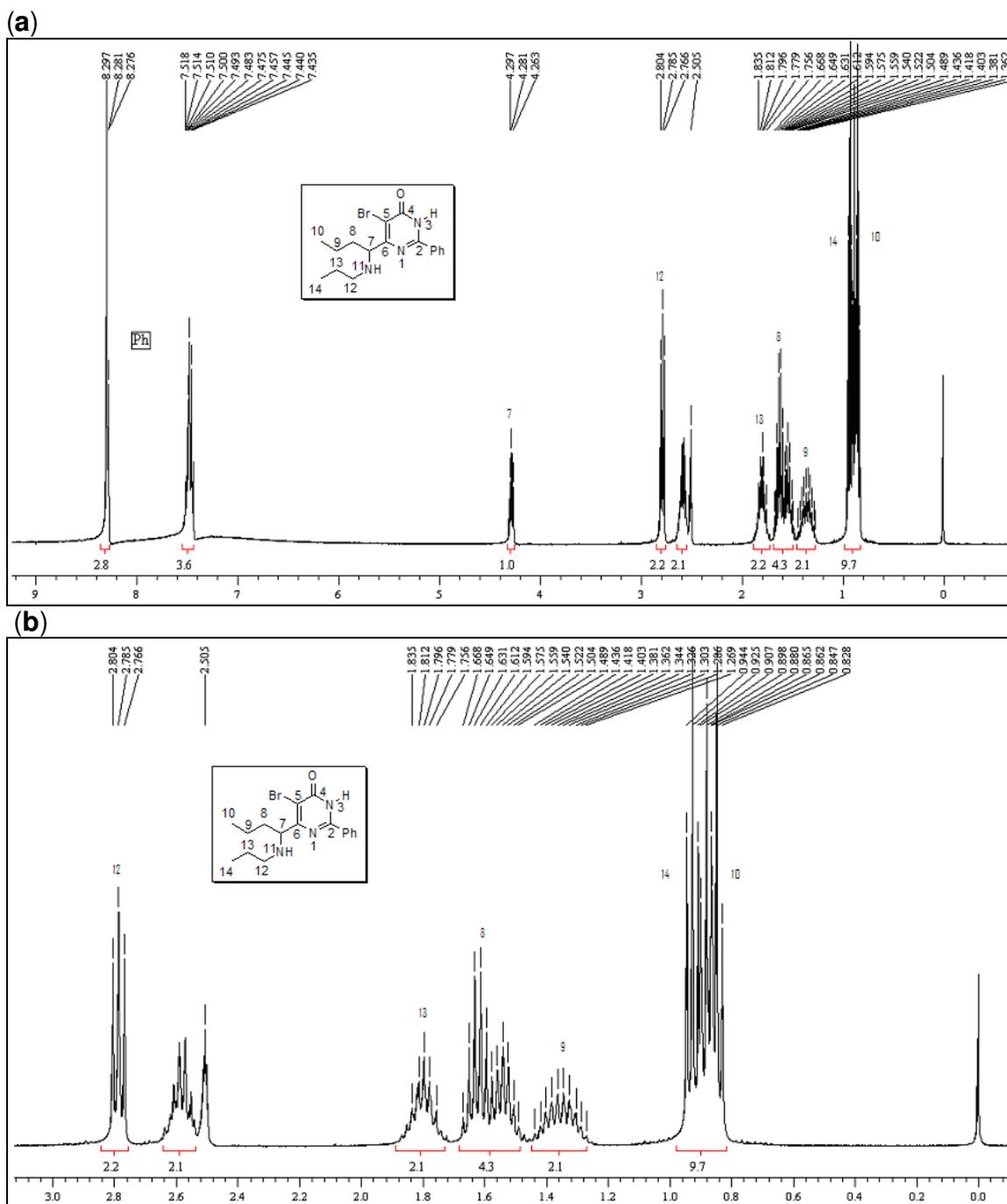
Figura 41: Espectro de (a) RMN  $^1\text{H}$  a 400 MHz em  $\text{DMSO-}d_6$  para o composto **10d** e (b) expansão do espectro de RMN  $^1\text{H}$  a 400 MHz em  $\text{DMSO-}d_6$  para o composto **10d**.
