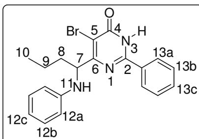
O produto foi obtido em forma de sólido, branco (91%); (P.F.= 213-217°C); CG-MS (IE, 70 eV) m/z (%): 397 (M<sup>+</sup>, 8), 354 (100), 274 (9), 148 (10), 104 (52), 77 (34); <sup>1</sup>H NMR (DMSO-*d*<sub>6</sub>, 200 MHz) δ = 0,94 (t, 3H, J<sub>H10-H9</sub> = 7,0 Hz, H10); 1,34-1,58 (m, 2H, H9); 1,67-1,86 (m, 2H, H8); 4,77 (t, 1H, J<sub>H7-H8</sub> = 8,0 Hz, H7); 6,01 (s.a., 1H, H11); 6,49 (t, 1H, J<sub>H12c-H12b</sub> = 7,2 Hz, H12c); 6,63 (d,
