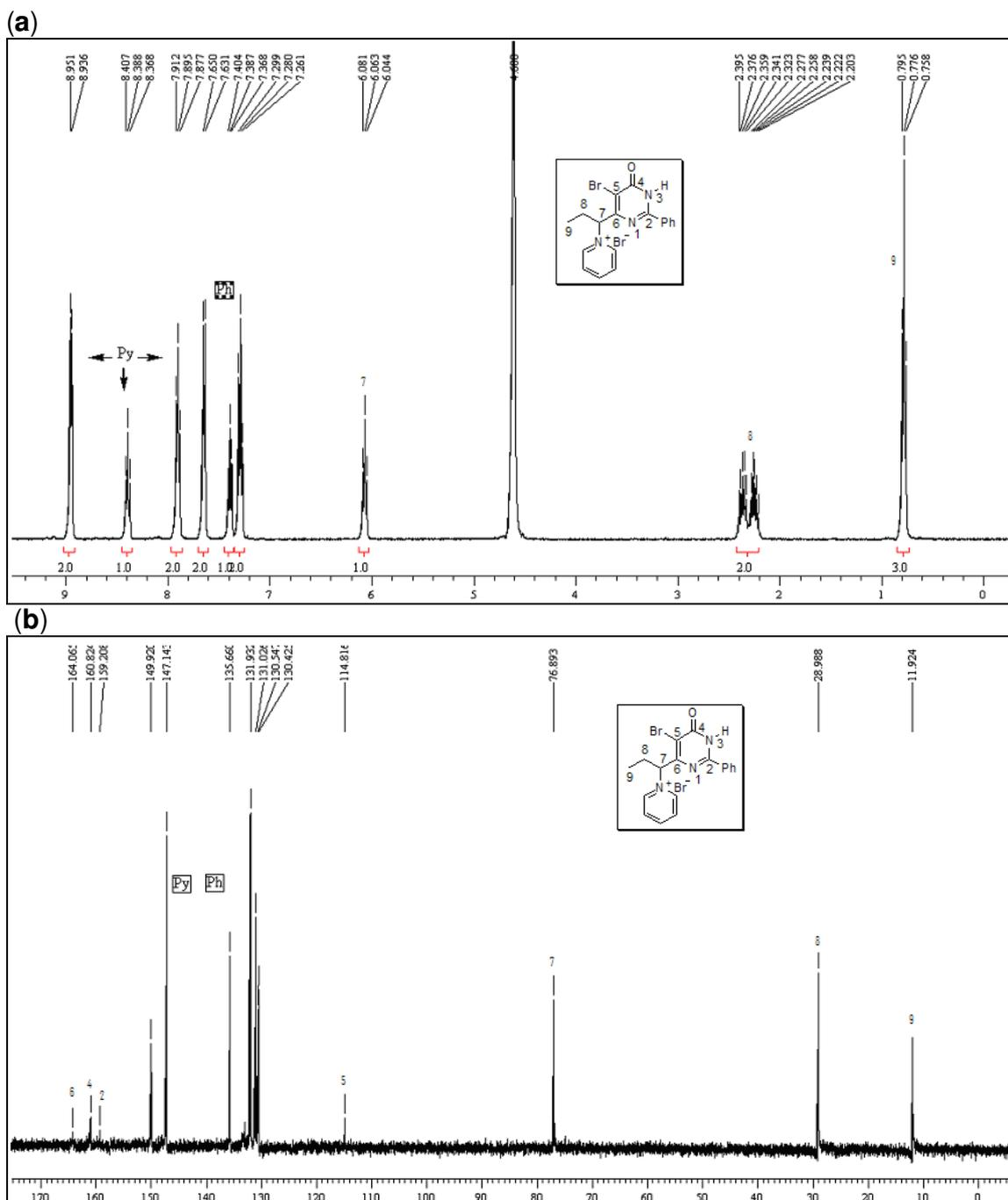
Figura 33: Espectro de (a) RMN  $^1\text{H}$  a 400 MHz em  $\text{D}_2\text{O}$  e espectro de (b) RMN  $^{13}\text{C}$  a 100 MHz em  $\text{D}_2\text{O}$  para o composto **8c**.
