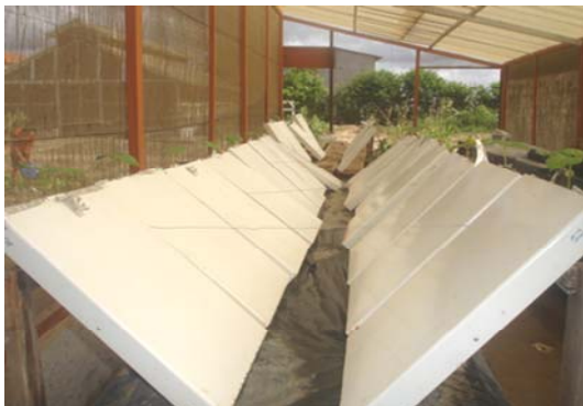
Figura 2: Rizotrons com inclinação de 25° para facilitar o crescimento do sistema radicular das plantas em casa de vegetação.
