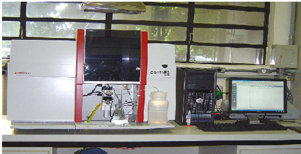
Figura 11. Espectrômetro de absorção atômica com fonte contínua de alta resolução AnalytikJena, modelo contrAA 300.
