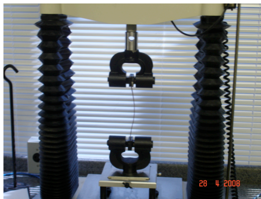
Figura 9. Análise de tensão com o Texturômetro TA.TX2 Stable Micro Systems.
