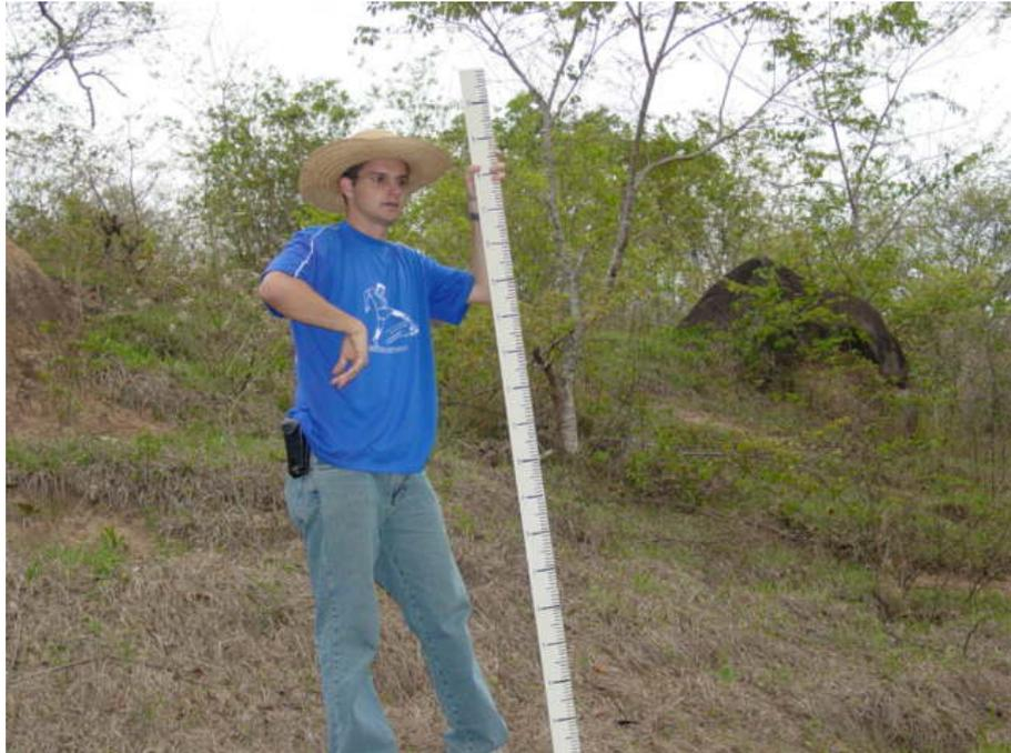
Foto 10: Medida do perfil topográfico a partir da margem esquerda do rio Araguari.
