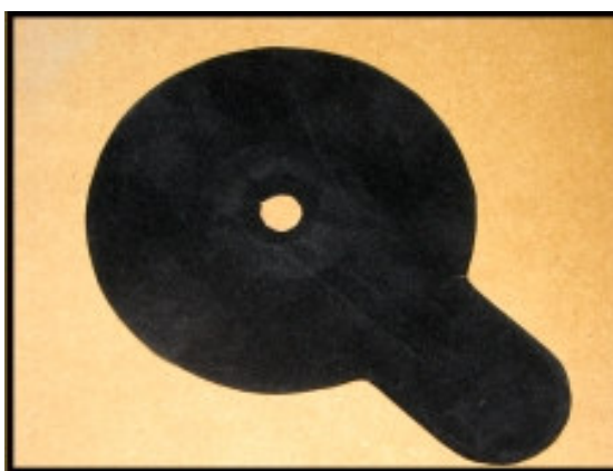
Figura 3.4: Máscara negra utilizada entre o sensor do espectrocolorímetro e as amostras de madeira.
