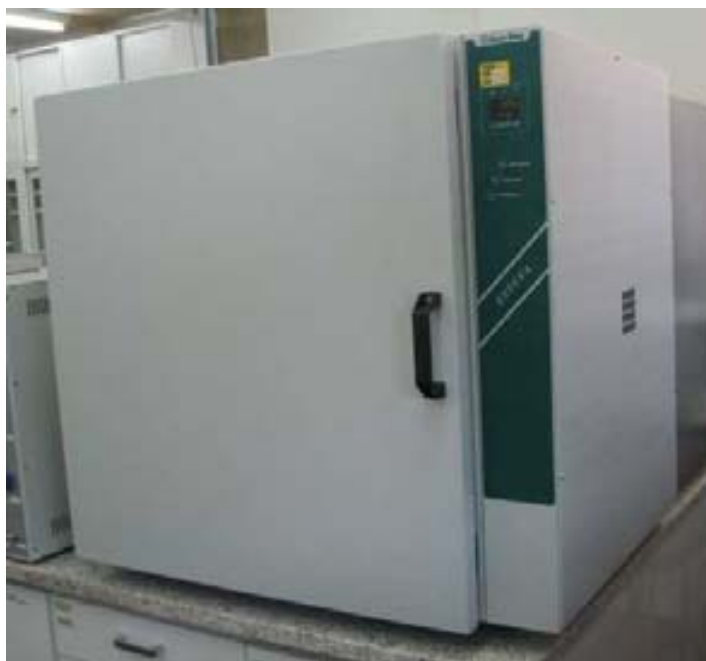
Figura 3.2: Estufa convencional de laboratório com circulação de ar forçada.
