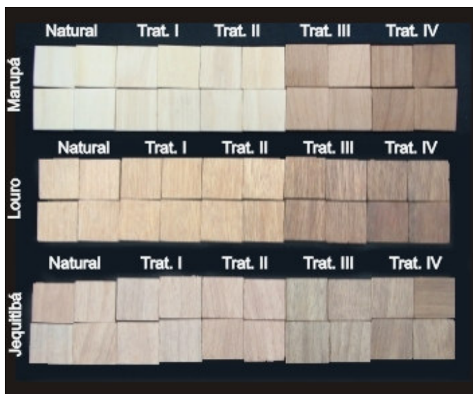
Figura 4.9: Efeito dos tratamentos térmicos aplicados sobre as amostras de Simarouba amara , Sextonia rubra e Cariniana micrantha (I: 150°C/1h; II: 150°C/2h; III: 200°C/1h; IV: 200°C/2h).
