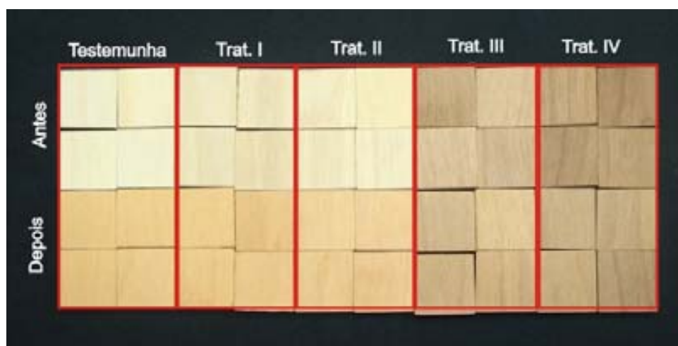
Figura 4.13: Aparência da madeira de marupá tratada termicamente antes e após 84 horas de irradiação ultravioleta.
