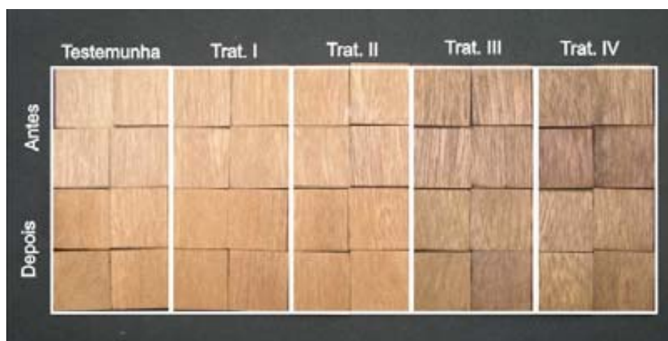
Figura 4.18: Aparência da madeira de louro-vermelho tratada termicamente antes e após 84 horas de irradiação ultravioleta.
