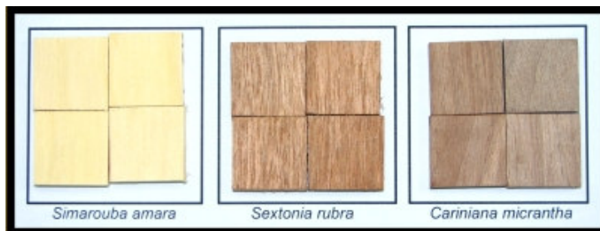
Figura 3.1: Condição natural da madeira das três espécies após fase de preparação dos corpos-de-prova.
