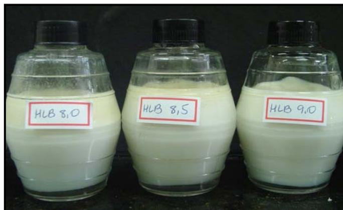
Figura 34. Emulsões óleo de laranja/água preparadas a partir da mistura de tensoativos Unitol L100/Unitol L20 com diferentes valores de HLB: (a) HLB na faixa de 6,4 a 11,0 (b) HLB na faixa de 8,0 a 9,0
