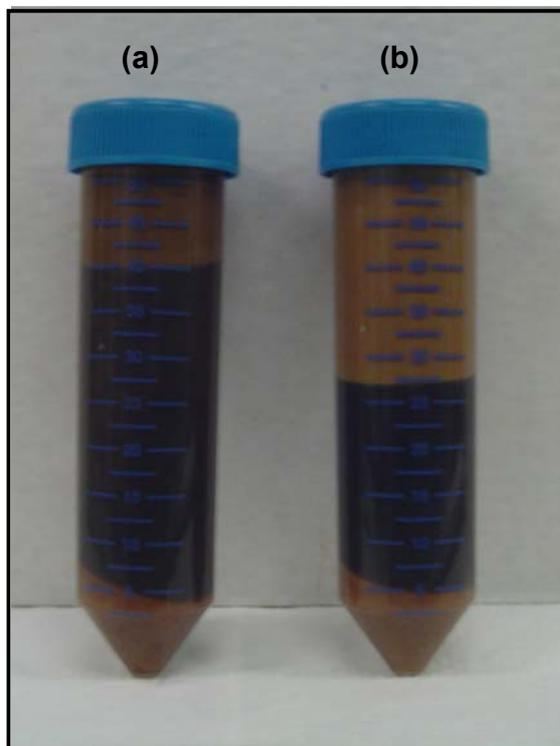
Figura 80. Aspecto dos sistemas de limpeza contendo a areia contaminada após o final do teste: (a) 10%*m/m* de tensoativo Unitol L60 e 30%*m/m* de óleo de laranja; (b) 8%*m/m* de tensoativo Unitol L60 e 14%*m/m* de óleo de laranja
