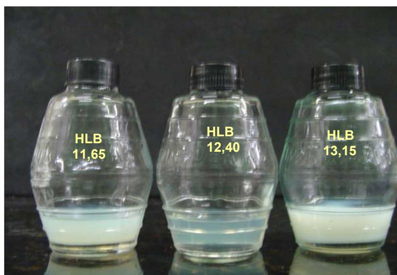
Figura 74. Foto das nanoemulsões óleo de laranja/água contendo 10% de mistura de tensoativo Unitol L100/Unitol L60 em 14%*m/m* de fase oleosa
