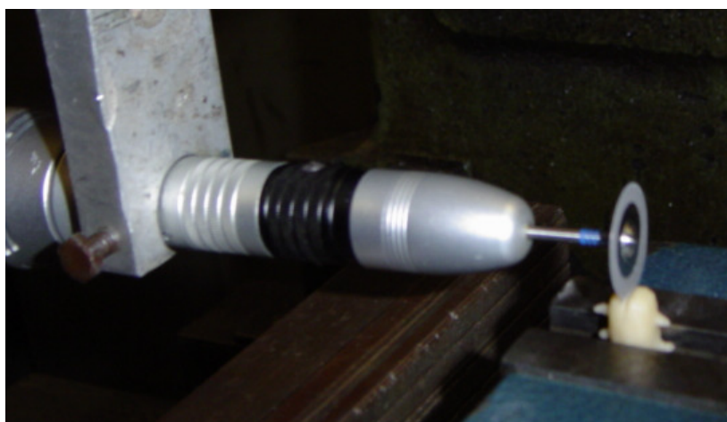
Figura 32 – Abertura de entalhe das amostras com disco diamantado.
