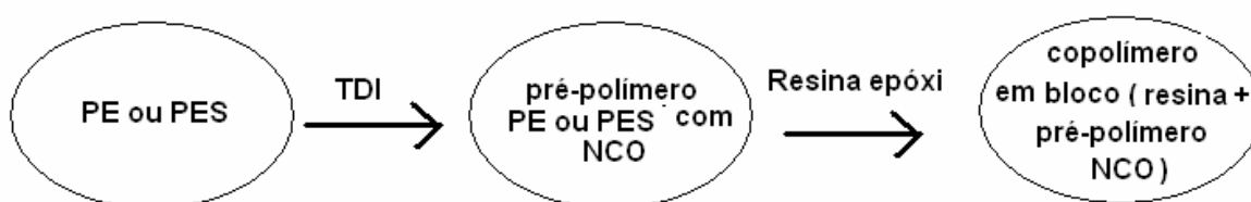
Figura 24 - Processos de modificação PE ou PES com TDI e obtenção do copolímero em bloco.
