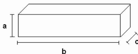
Figura 28 - Dimensões do corpo de prova para ensaio de impacto instrumentado Izod: a) largura (11,0 mm); b) comprimento (55,0 mm); c) espessura (6,5 mm).
