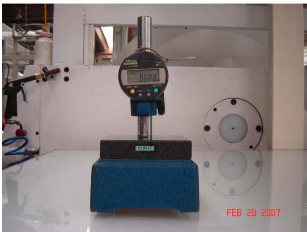
Figura 11: Aparelho utilizado para medir espessura
