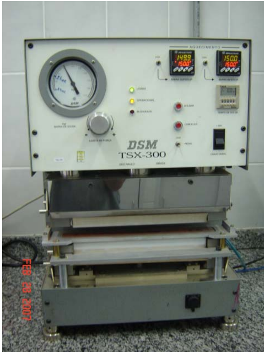
Figura 16: Máquina Utilizada para as Medidas de Força de Solda
