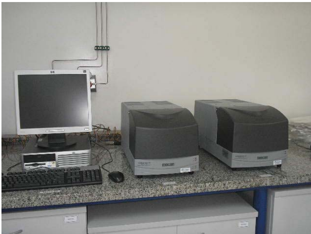
Figura 18: Aparelho utilizado Barreira a vapor d'Água
