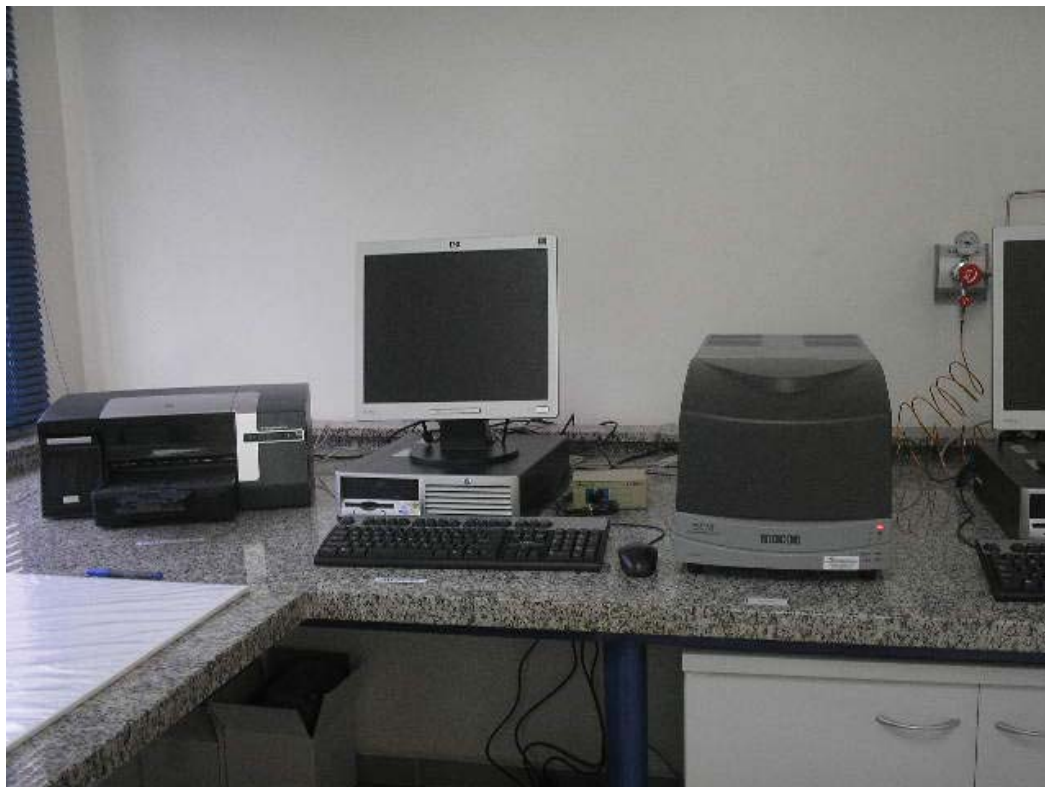
Figura 17: Aparelho Utilizado na Medida de Barreira à Oxigênio
