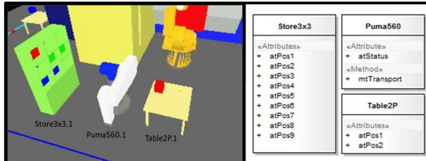
**Figura 34:** Representação parcial da célula de manufatura
