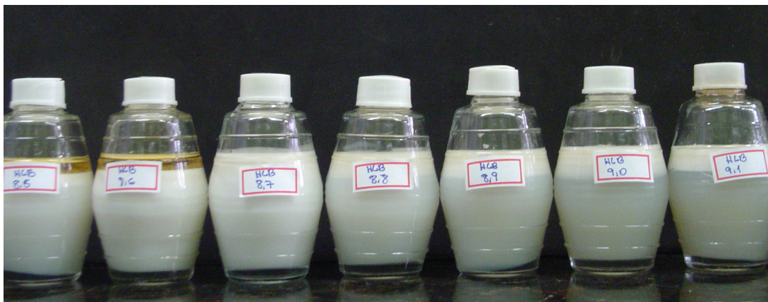
Figura 34. Emulsões óleo de laranja/água preparadas a partir da mistura de tensoativos Unitol L100/Unitol L20 com diferentes valores de HLB: na faixa compreendida entre 8,5 e 9,1
