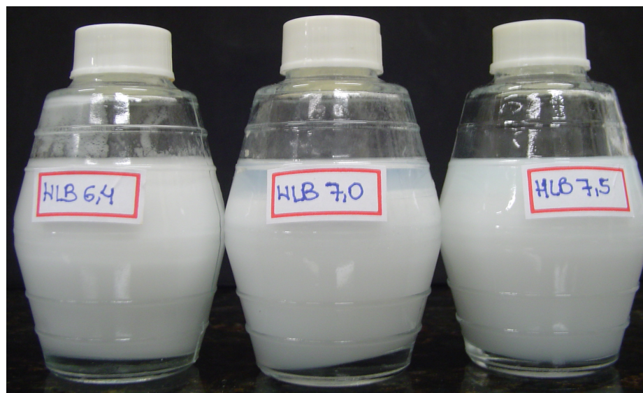
Figura 32. Emulsões terpeno de laranja/água preparadas a partir da mistura de tensoativos Unitol L100/Unitol L20 com valores de HLB 6,4, 7,0 e 7,5
