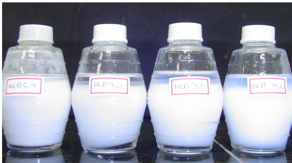
Figura 31. Emulsões DTC/água preparadas a partir da mistura de tensoativos Unitol L100/Unitol L20 com diferentes valores de HLB: faixa de 6,4 a 8,0
