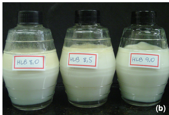
Figura 33. Emulsões óleo de laranja/água preparadas a partir da mistura de tensoativos Unitol L100/Unitol L20 com diferentes valores de HLB: (a) HLB na faixa de 6,4 a 11,0 (b) HLB na faixa de 8,0 a 9,0
