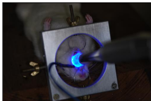
FIGURA 11 – LED e termístor em posição na região central da mucosa.
