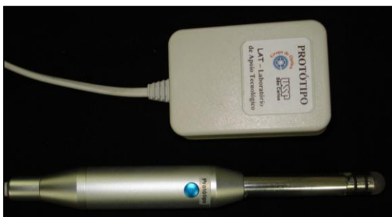
FIGURA 4 – PROTÓTIPO DE LED - Aparelho constituído de LEDs utilizado para iluminação das amostras.
